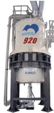
図 1・3 920 MHz NMR 磁石 (物質・材料研究機構)
