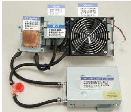
図 2-49 パソコン向け水冷システム
