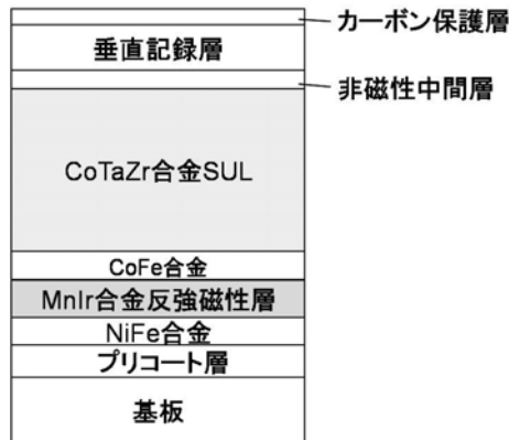
図 2・11 SUL の磁化をピン止めた媒体の構成例
